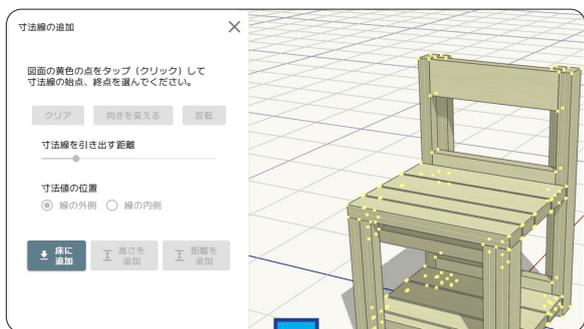
寸法線の追加画面に切り替わると、右側にモデルが表示され、寸法線の始点、終点の候補となる点が黄色で表示されます。
