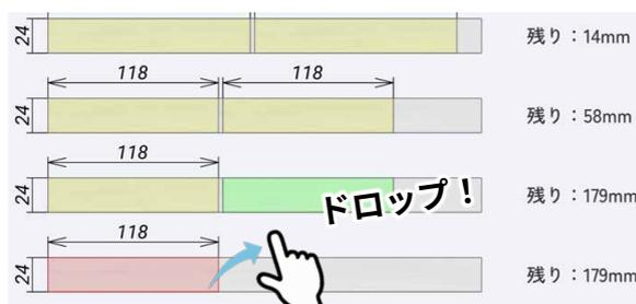
材料をドラッグして別の規格材料上でドロップすると、二つの材料を一つの規格材料上にまとめることができます。
