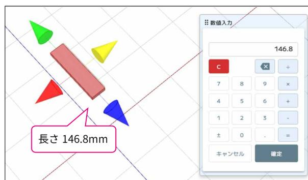
すると、自動で計算され、角材の長さが 146.8mm に変更されます。このように、手計算が必要な場合でも、数値入力パネルを使えば簡単に計算しながら設計を進めることができます。
